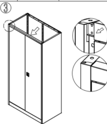
Kiinnitä ovenkarmi molempiin sivupaneelisiin
